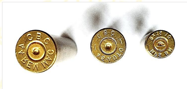
83. ábra: A csappantyú elhelyezkedése a lőszerhüvelyben
