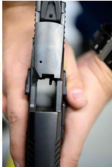
94. ábra: A tár helye és a tűzfal ellenőrzése
