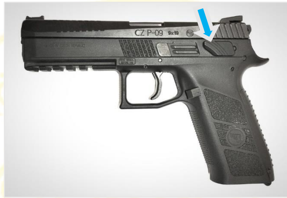
104. ábra: A CZ P-09 szolgálati pisztoly fesztelenítőkarnja és a használat iránya
