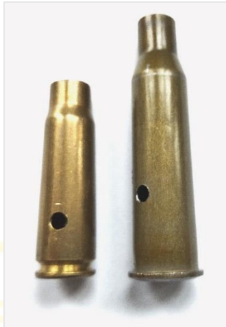
81. ábra: Hornyos és peremes lőszer-hüvelyek 7,62x39 és 7,62x54R kaliberben
