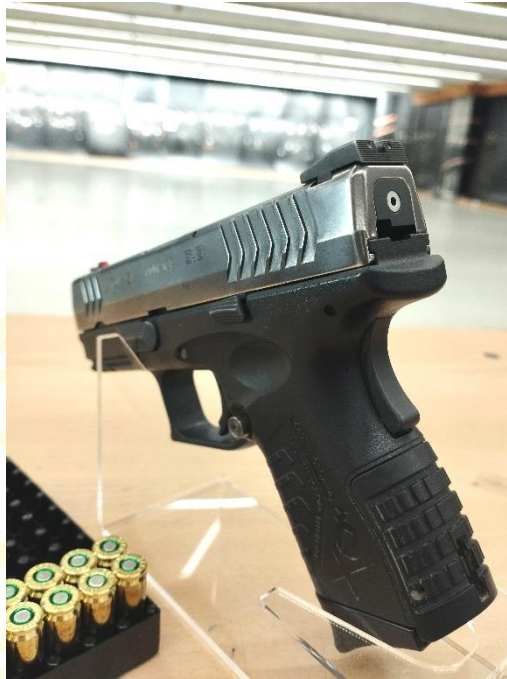
58. ábra: Markolatbiztosító egy HS (Spingfield) XDm 3.8 9mm Luger pisztolyon
