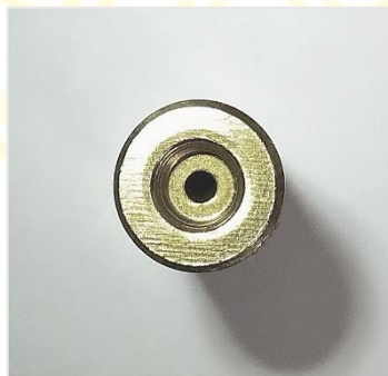
84. ábra: Boxer-csappantyú helye a 9x19-es lőszerhüvelyben
