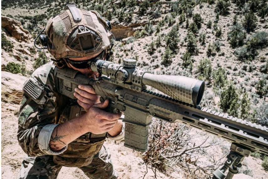
75. ábra: Picatinny sín a fegyvercső felett, a céltávcső rögzítésére (Forrás: SteinerDefense)
