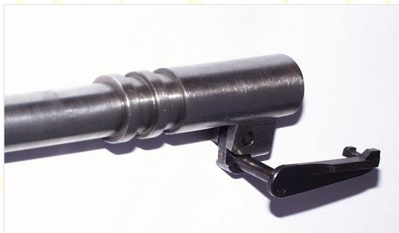
48. ábra: A cső a kengyellel és a tokhoz kapcsolt vezérlőtengellyel
