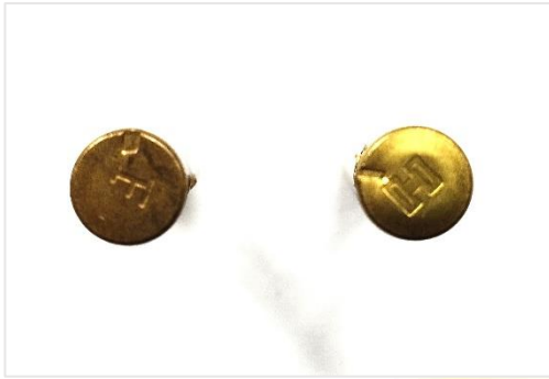
85. ábra: Elműködtetett peremgyújtású lőszer hüvelytalpa (Forrás: Gáspár Miklós felvétele)
