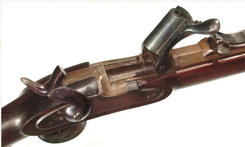
7. ábra: Wänzel-féle puska felfelé nyíló csapó zára
