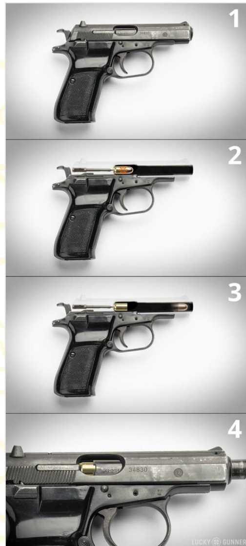
44. ábra: Súlyzárás működési rendszer
