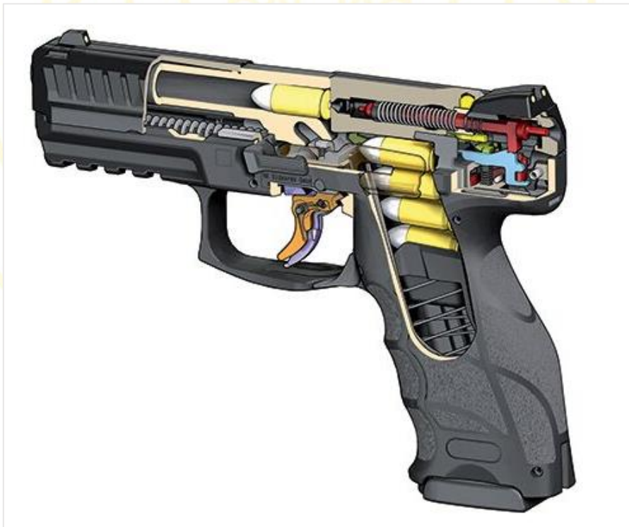
66. ábra: A striker rendszer
