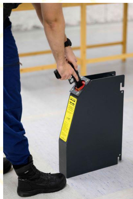
92. ábra: Töltetlenség ellenőrzése pisztollyal – lövedékfogó használata
