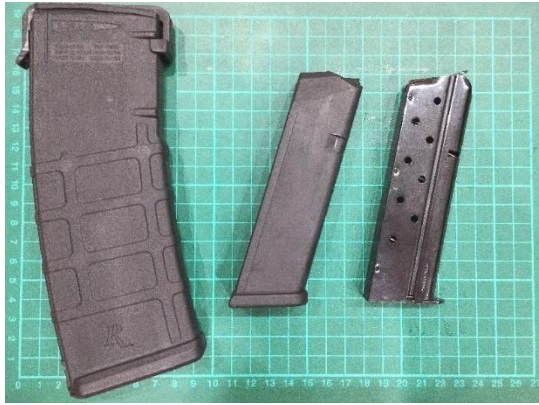
56. ábra: Kétsoros és egysoros szekrénytárak (Forrás: Gáspár Miklós felvétele)
