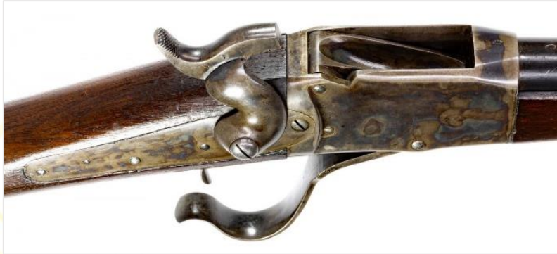
9. ábra: Peabody puska zárszerkezete
