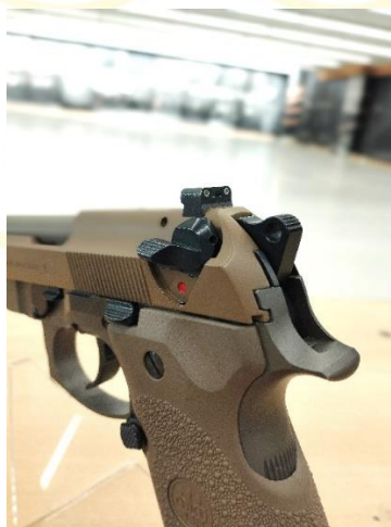
57. ábra: Biztosító-/fesztelenítőkar egy Beretta 92 F 9mm Luger pisztolyon
