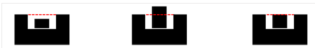
39. ábra: A céltüske (hasáb) helyzete pontos célzáskor
